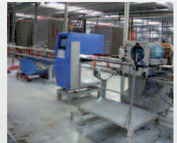
CeraScreener® Anlage mit Ausschleusung
